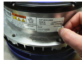
Esimerkki: FCC/IC-tarran "EM-W" inside kiinnitys puhaltimen vaippaan.
