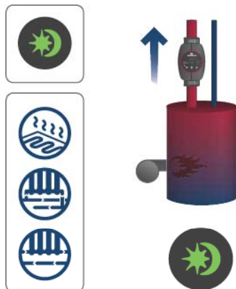
Kuva 23 Automaattinen yöpudotus on päällä, ja vihreä merkkivalo palaa
